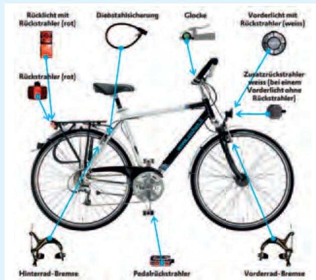
Alle sicherheitsrelevanten Teile werden begutachtet
