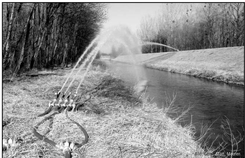
Beidseits des Binnenkanles im Gebiet Spetzau wurden über 24 Stunden je 1000 l/min. für den Grosspumpversuch entnommen.
