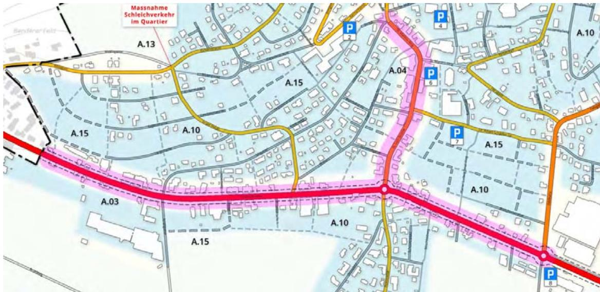
Abbildung 3: Ausschnitt aus dem Verkehrsrichtplan, Teilrichtplan motorisierter Individualverkehr. Die Korridorsicherung ist mittels grau gestrichelter Linien dargestellt. Der Abschnitt, in welchem das Betriebs- und Gestaltungskonzept erarbeitet werden soll, ist violett gekennzeichnet.
