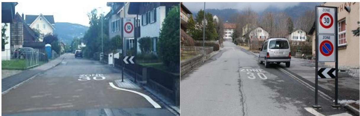
Abb. 11: Beispiele für Torsituationen (Quelle: Kantonspolizei St. Gallen, verkehr s ingenieure)
